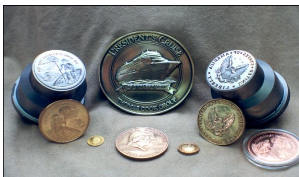
شکل ۳-۲۸ ابزار و سکه های تولید شده بوسیله آن ( فرایندهای مدرن سکه زنی )
