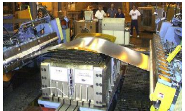
شکل ۲-۲۶ . فرایند شکل دهی کششی.
