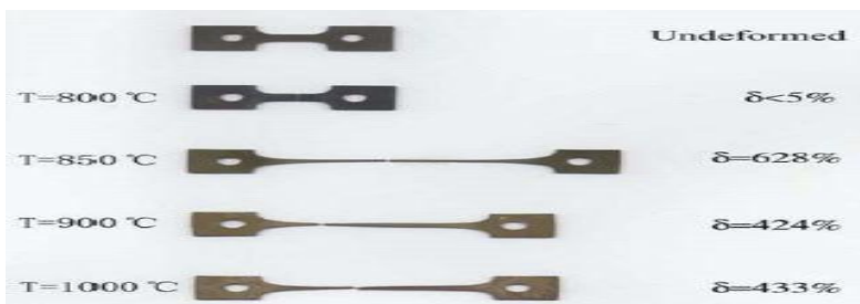
شکل ۲-۴۴. در فرایندهای شکل دهی ابر مومسان امکان افزایش طولهای شگفت اورمیسر است.
